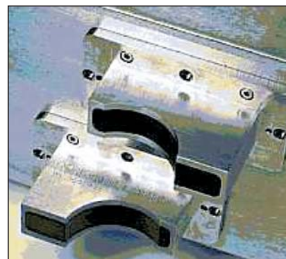
Abb. 14: Prüfkopf-Anordnung für Schweißnahtprüfung
