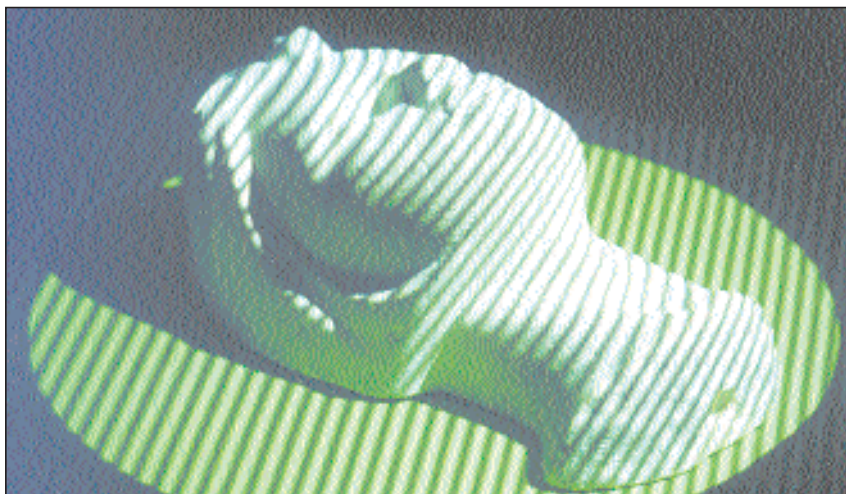
Eine mit Streifenmuster beleuchtete Figur zum optischen Vermessen der Oberflächenform
