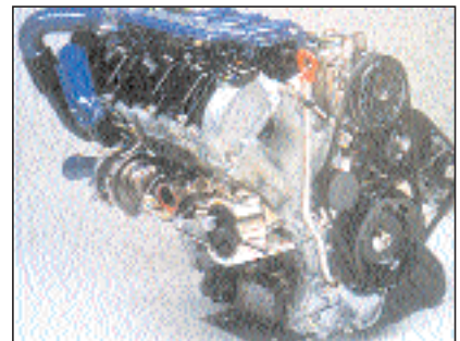
Der Smart-Motor (3-Zylinder-Ottomotor mit Turbolader)
