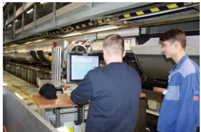
Die Ergebnisse der Ultraschallprüfung werden am Bildschirm angezeigt
