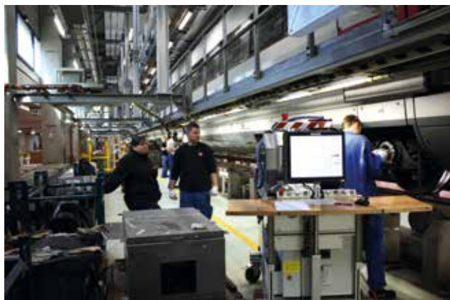
Christine Tolk mit Kollegen bei der Prüfung einer Radsatzwelle mit Längsbohrung
