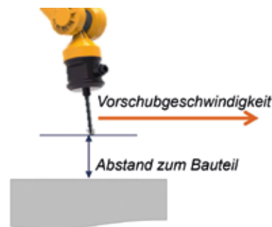
Zwei wichtige Einflussfaktoren beim Roboterschnüffeln: Vorschubgeschwindigkeit und Distanz der Messspitze. Quelle: INFICON.
