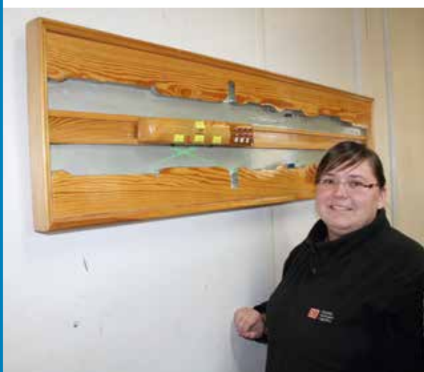
Christine Tolk vor dem Modell einer Radsatzwelle, das den Ultraschall „sichtbar“ macht
