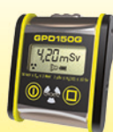
Elektronische Dosimeter: GPD150G und ED150 mit akustischer sowie optischer Warnung beim Überschreiten der akkumulierten Dosisgrenzen. Klein und robust.
