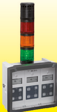
Raumüberwachungsmonitor: WS05C-1/C-2/C-3 mit optischer und akustischer Warnung zur Dosisleistungsüberwachung von Bestrahlungsräumen
