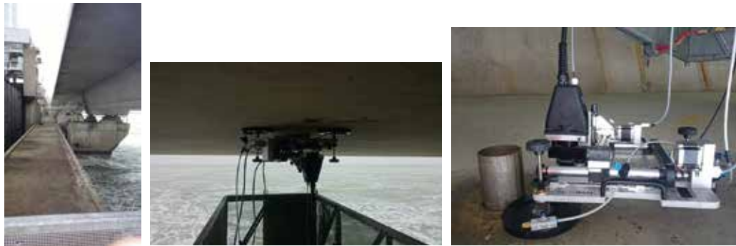
Abbildung 2: Links: Ansicht des zu untersuchenden Brückenabschnittes eines Küstenschutzbauwerkes an der Nordsee. Mitte: Brückenuntersichtgerät mit mobilem LIBS-Gerät. Rechts: Detailansicht des an der Unterseite des Brückenteils positionierten Scanners. Die Befestigung erfolgte über Unterdruck in den drei Saugfüßen des Scanners.
