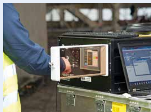
Mobiles LIBS-Gerät (Laser Induced Breakdown Spectroscopy) zur On-Site-Analyse von Schäden an der Beton-Infrastruktur – BauLIBS
