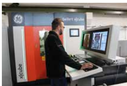
GE Seifert X/Cube im Röntgen-Einsatz
