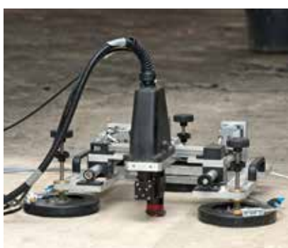
Abbildung 1: Steuergerät des mobilen LIBS-Systems (links). Scanner des mobilen LIBS-Gerätes (Mitte). Typisches Ergebnis - farbcodierte Chlor-Konzentration ermittelt auf der Querschnittsfläche eines Bohrkerne mit den Abmessungen 90 mm x 120 mm (rechts). Deutlich ist die lokal erhöhte Konzentration im Bereich des Risses zu erkennen.
