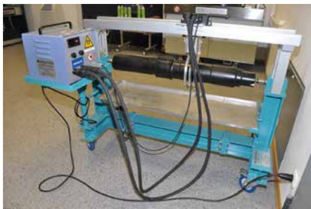
Wellenprüfung mit Überlaufspule für die praktische Ausbildung in der Magnetpulverprüfung, rechts: Detail
