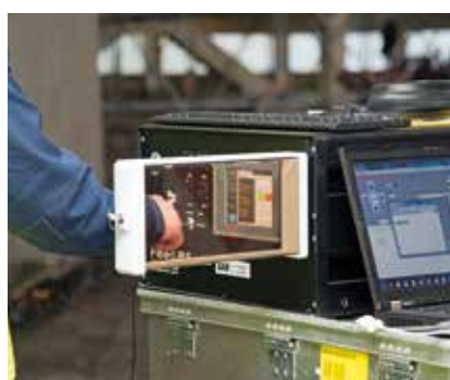
Abbildung 1: Steuergerät des mobilen LIBS-Systems (links). Scanner des mobilen LIBS-Gerätes (Mitte). Typisches Ergebnis - farbcodierte Chlor-Konzentration ermittelt auf der Querschnittsfläche eines Bohrkerne mit den Abmessungen 90 mm x 120 mm (rechts). Deutlich ist die lokal erhöhte Konzentration im Bereich des Risses zu erkennen.
