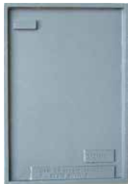
Abb. 01-2 Vergleichsmuster BNIF 1/0S1, R_a \leq 6,3 \mu\text{m} Quelle: Archiv my
