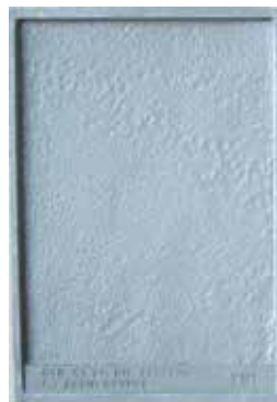
Abb. 01-3 Vergleichsmuster BNIF, 2S1, R_a \leq 12,5 \mu\text{m} Quelle: Archiv my
