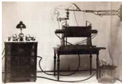
Seifert Röntgentisch mit Funkeninduktor 1896
