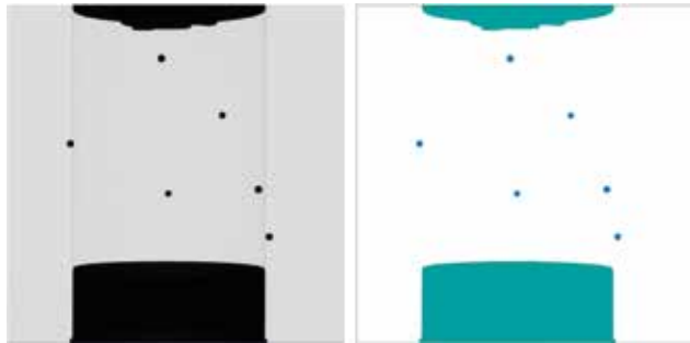
Abb. 6: Segmentierung der Markerprojektionen: Links: Eine Röntgenprojektion der Markergeometrie. Rechts: Anhand einer Extraktion des Vordergrunds und weniger Kugelkriterien lassen sich die Markerprojektionen (blau) von anderen Strukturen (türkisfarben) und dem Hintergrund (weiß) unterscheiden.
