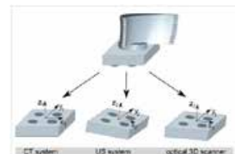
Abbildung 2: Mit dem optischen Scanner aufgenommene Turbinenschaufel (oben) sowie das verwendete Kalibrierverfahren zur Registrierung des CT, Ultraschall (US) und optischen Datensatzes.
