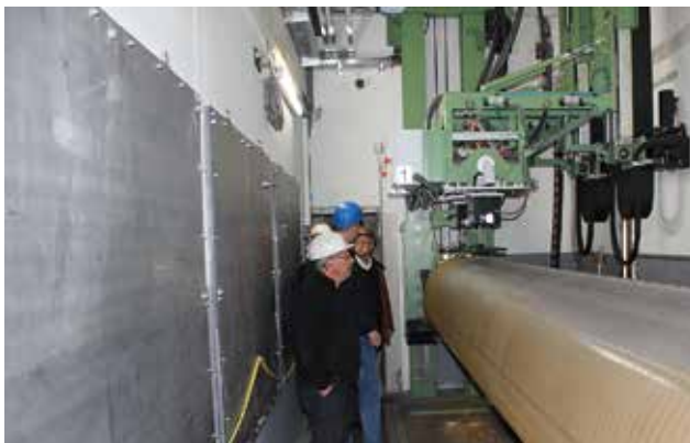
Automatisierte Rohrprüfung im Röntgenbunker
