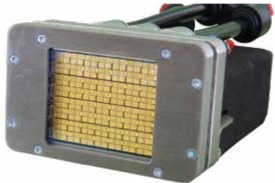
Abb. 1: VCSEL-Array Modul am IKT
