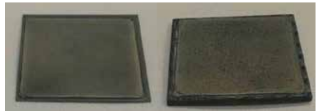
Abb. 5: Trägersubstrate mit keramischer Hitzeschutzschicht aus Yttriumsilikat
