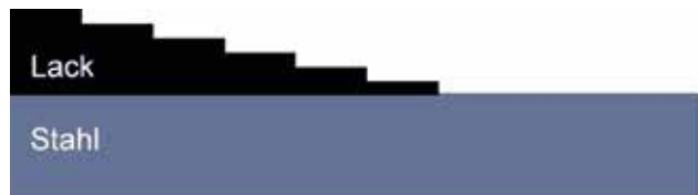
Abb. 2: Schema des Lack-Stufenkeils
