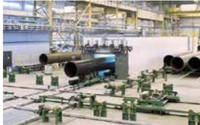
Röntgeninspektion von Rohrleitungen
