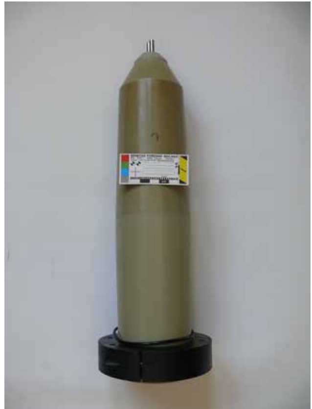
Isolator mit Durchschlag
