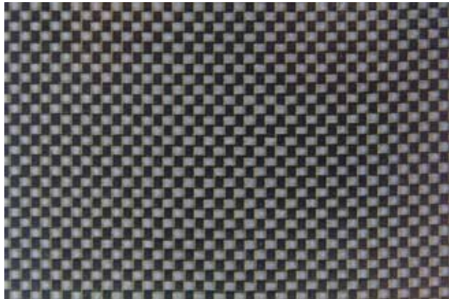
Nahaufnahme an einer 8 mm starken CFK-Platte aus der Luftfahrt. Hochleistungs-CFK-Gewebe mit 0°/90°-Lagenaufbau
