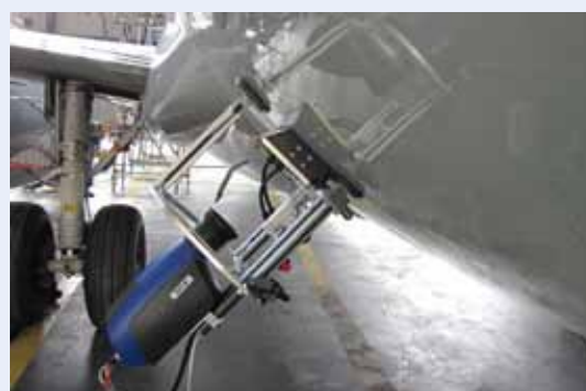
Fachbeitrag über Induktionsthermografie zur automatisierten Rissprüfung von Flugzeugstrukturen aus Aluminium
