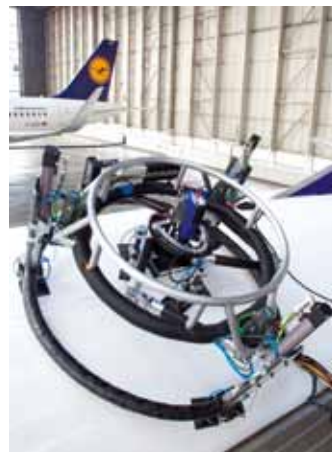
Abb. 11: Prüfkopf im Einsatz (integriert in den autonomen Roboter)
