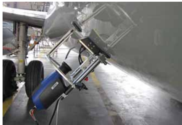
Abb. 10: Prüfkopf im Einsatz (als Stand-Alone-Lösung)
