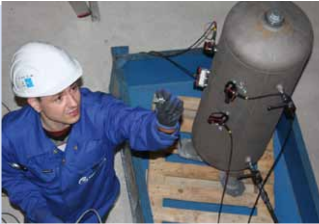
Christian Zinc befestigt die Sensoren am Behälter
