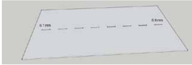
Abb. 5: Probekörper zur Bestimmung der Detektion von verdeckten Rissen
