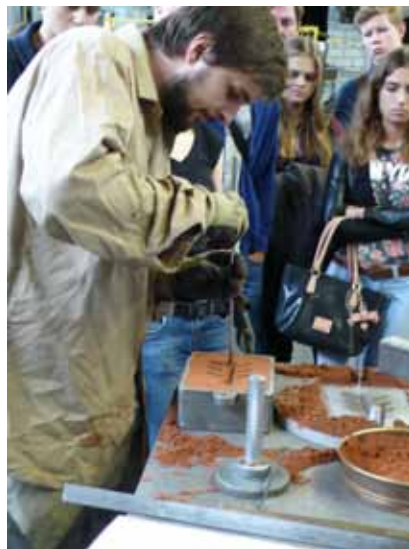
Herstellen der verlorenen Form (Sandguss)
