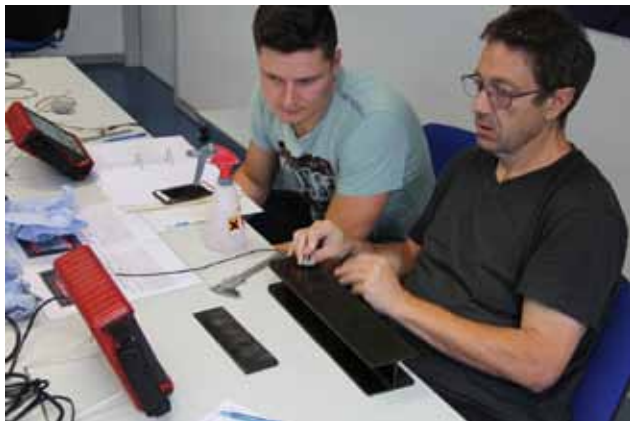
CFK Prüfung mit Kontakttechnik
