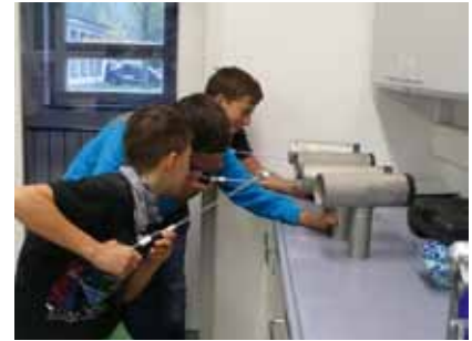
Sichtprüfung mit Handspiegel
