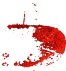
Abbildung 10: Visualisierung des Haupt-Ermüdungsrissses der LCF-Probe aus Datensatz mit der Streuebene des Analysatorkristalls parallel zur Faserrichtung.
