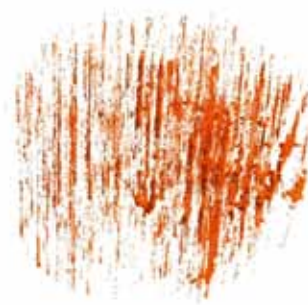
Abbildung 11: Visualisierung der Ermüdungsrisse entlang der Faseroberflächen der LCF-Probe aus Datensatz mit der Streuebene des Analysatorkristalls senkrecht zur Faserrichtung
