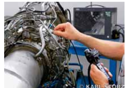
Die neueste Generation von Mess- und Dokumentationssystemen für die endoskopische, zerstörungsfreie Prüfung von Bauteilen
