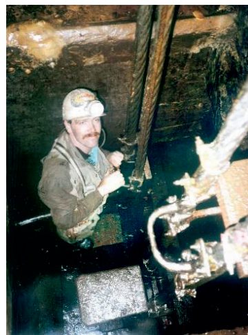
Abb. 5.: Konventionelle Seilprüfung im Bergwerk unter der Erde
