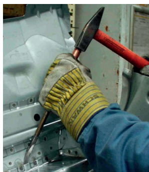
Zerstörende Prüfung mit Hammer und Meißel
