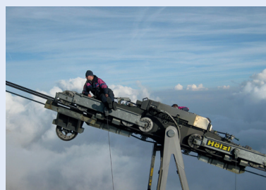
Gerät zur optischen Prüfung von Stahlseilen erhielt den Anwenderpreis der DGZfP 42
