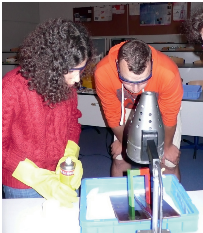
MT mit Schulmagneten: Kommt eine Anzeige? (li.: Ekin aus Istanbul)
