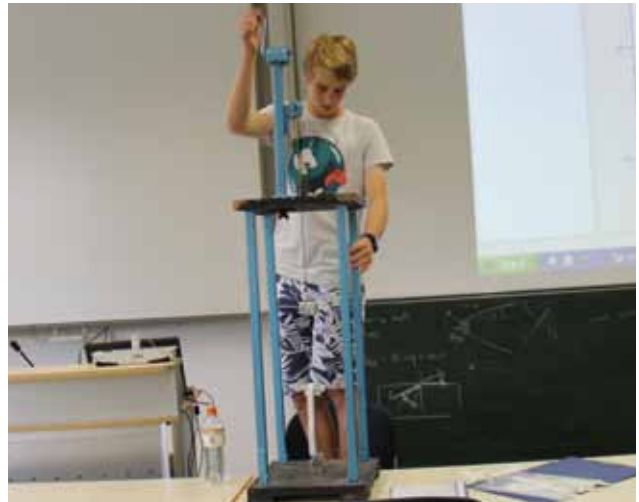
Schüler Mathis Edelmann führt sein Programm zur Messung der Reißfestigkeit von Papier vor
