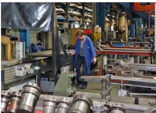
Prüfanlage für Kuppelstangen
