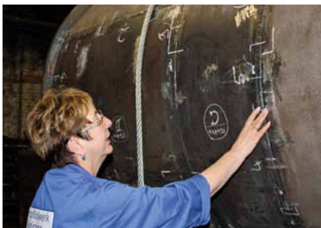
Hannelore Danowski markiert Schweißnähte für die Röntgenprüfung
