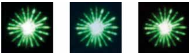
Abb. 1: links: klar, scharfe Anzeige mit maximalem Kontrast (gefilterten UV-LED-Leuchte) Mitte: kontrastärmere, leicht unscharfe Anzeige (ungefilterte UV-LED-Leuchte) rechts: klassische Anzeige (Quecksilberdampflampe)
