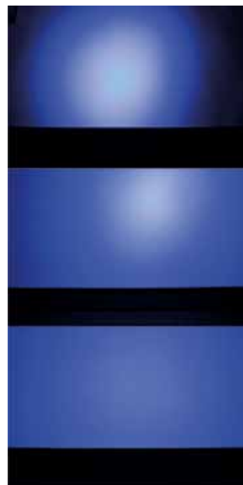
Abb 3: Vergleich des Ausleuchtungsbereichs in 30 cm Abstand oben: schlechte UV-LED-Leuchte Mitte: 100W Quecksilberdampflampe unten: ideale UV-LED-Leuchte
