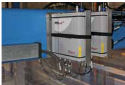
PROline USB Fehlerprüfung – Wanddickenmessung von nahtlosen Rohren
