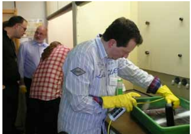
Magnetpulverprüfung mit Handjoch und Schulmagneten, Experimente von Anke Bachran und Bernd Bader (Cantor Gymnasium, Halle)
