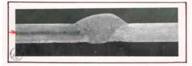
Abbildung 8: Metallografische Wiedergabe des Querschliffes der Schweißnaht von Abbildung 7 mit Doppelung und Seigerungen in einem Rohranschluss
