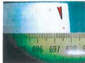
Abbildung 4: Eindringprüfungsanzeige an einer blecheben beschliffenen Lamellenpaketschweißnaht
