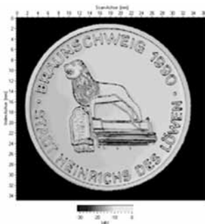
C-Bild einer Münze Prüfkopf 80 MHz fokussiert Bild: Dr. Hillger
