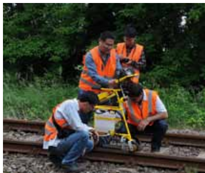
Schienenprüfung mit Ultraschall in der praktischen Anwendung
