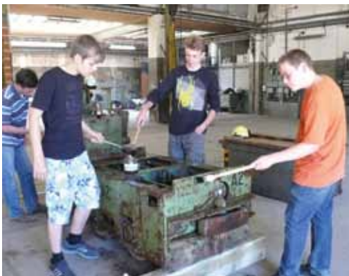
Nach dem Trockeneisstrahlen die Rostversiegelung
