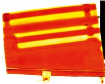
„Phasenbild einer Messung mit Lockin-Thermografie. Dargestellt ist der Ausschnitt eines CFK-Seitenleitwerks mit künstlichen Impact-Schäden.“
