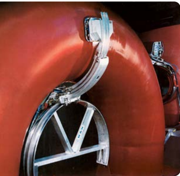
Abb. 4: Manipulator zur Ultraschallprüfung des 180°-Rohrbogens der Volumenausgleichsleitung [MAN; 1985]
