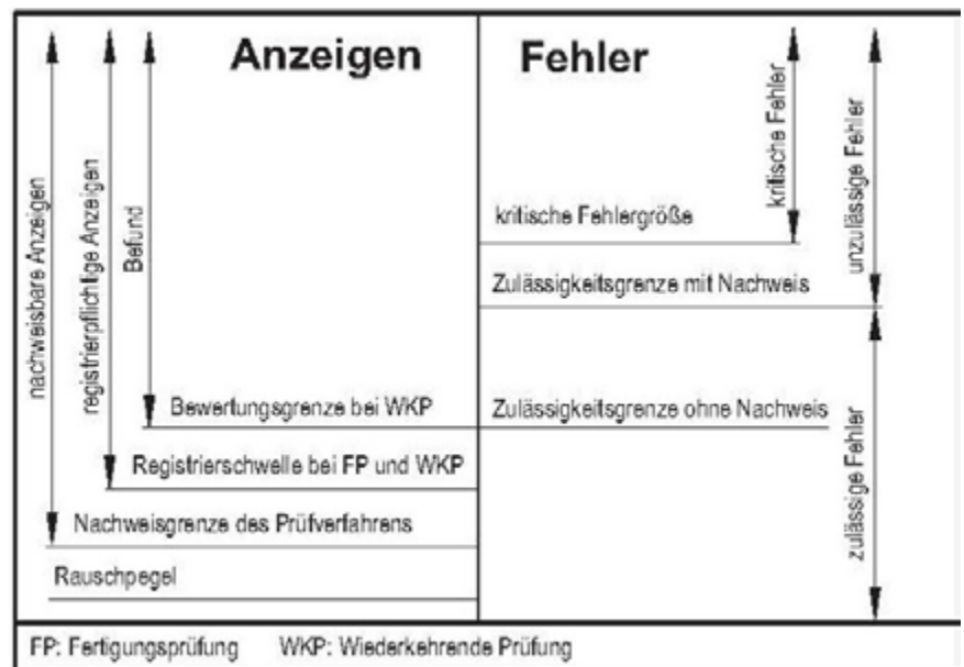
Abb. 3: Definition von „Anzeigen“ und „Fehlern“ nach KTA 3201.4 und KTA 3211.4 [KTA]
