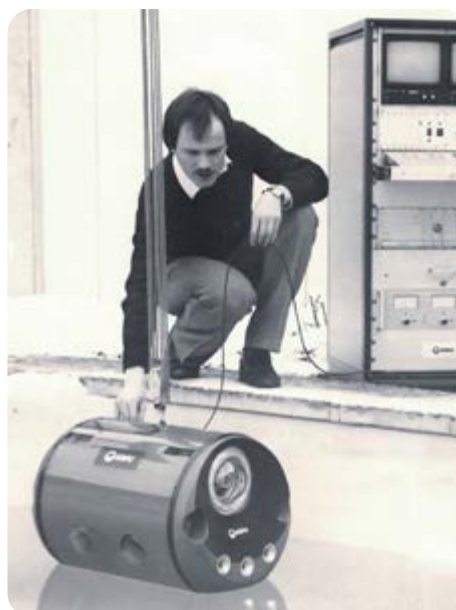
Abb. 6: Ferngesteuertes U-Boot ROMIS als Unterwasserdrohne zur Sichtprüfung [KWU; 1984]
