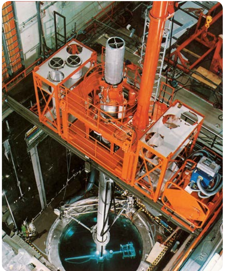
Abb. 5: Zentralmastmanipulator (ZMM) zur Ultraschallprüfung (unten im Bild) des Reaktordruckbehälterunterteils [MAN/KWU; 1985]
