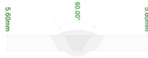
Bild 1: Schweißnahtvorbereitung, beispielhaft
