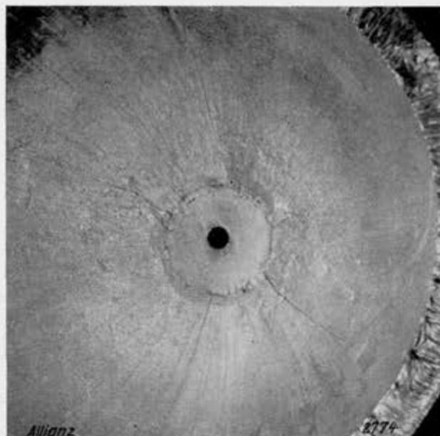
Abb. 35. Magnetbild eines gekümpelten Kesselbodens mit Radialrissen.
