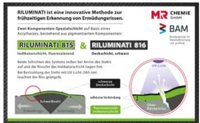
geworden, können Experten diese durch die klassischen Verfahren verifizieren. Riluminati und das Risslumineszenzverfahren sind somit in der Lage, die Risskontrollen an Stahlbauwerken wesentlich zu vereinfachen und die Inspektionsdichte ohne großen Aufwand zu erhöhen. Mögliche Maßnahmen können so frühzeitig getroffen werden, bevor ein ordnungsmäßiger Betrieb nicht mehr gewährleistet ist.
