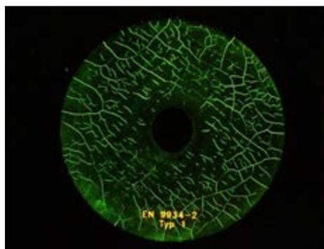
Bild 1: Vergleichskörper 1 gemäß DIN EN ISO 9934-2, Anzeige eines fluoreszierenden Magnetpulvers (Ölsuspension), Qualitätsbestimmung über Vergleich möglich
