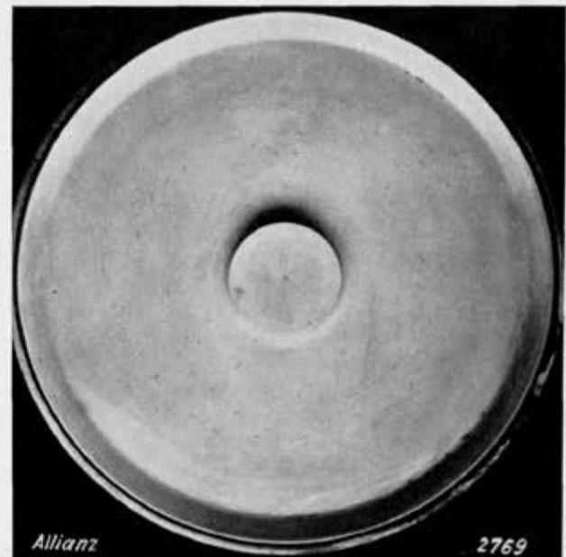
Abb. 29. Magnetbild einer nach dem Stromdurchflutungsverfahren geprüften Turbinenscheibe mit zahlreichen Rissen.
