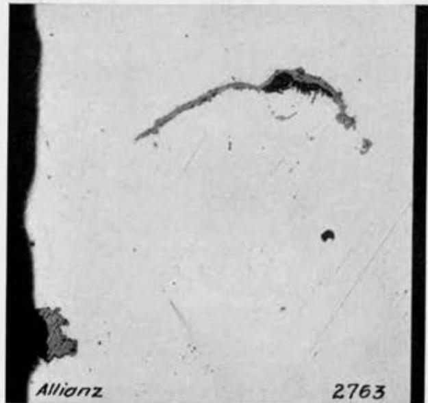
Abb. 23. Schliffbild des Stahlgußkörpers nach Abb. 22 mit Schlackeneinschlüssen.  $V = 200$ .
