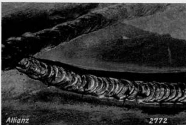
Abb. 33. Magnetbild einer Kehlschweißnaht an einer Verstärkerlamelle mit Rissen.
