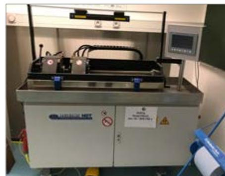
Magnetpulverprüfbank mit Touchpanelbedienung
