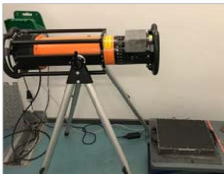
Röntgeneinrichtung mit Detektor (DDA)
