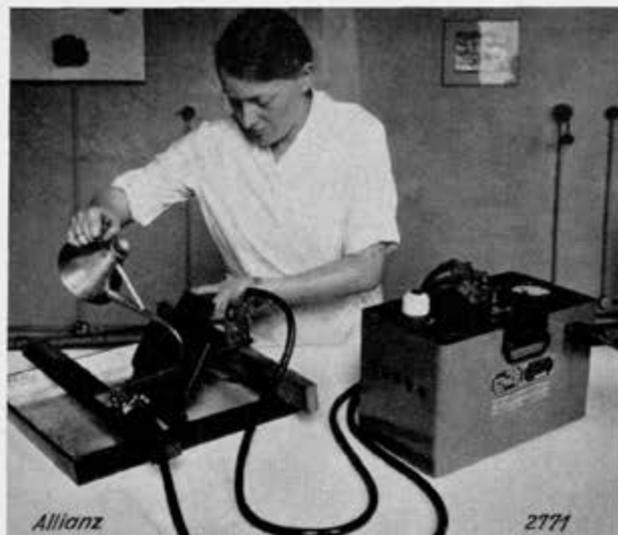
Abb. 32. Nietloch- und Schweißnaht-Prüfer nach Dr. Berthold, Bauart E. Heubach. Aufnahme: Werkphoto
