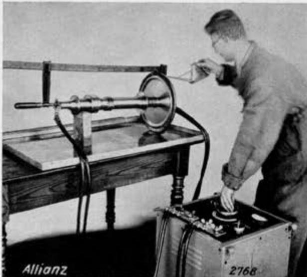
Abb. 28. Ortsbewegliches Stromdurchflutungsgerät, Bauart E. Heubach, bei der Prüfung von Turbinenläufern.
