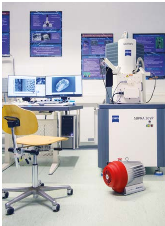
Modernste Pumpentechnologie von Pfeiffer Vacuum im Einsatz bei einem ZEISS Rasterelektronenmikroskop am Schülerforschungszentrum Nordhessen
