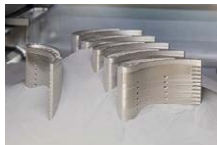
Im Kompetenzzentrum Additive Fertigung der BAM werden eine Vielzahl an Verfahren erprobt, wie hier beispielsweise der 3D-Druck metallischer Bauteile
