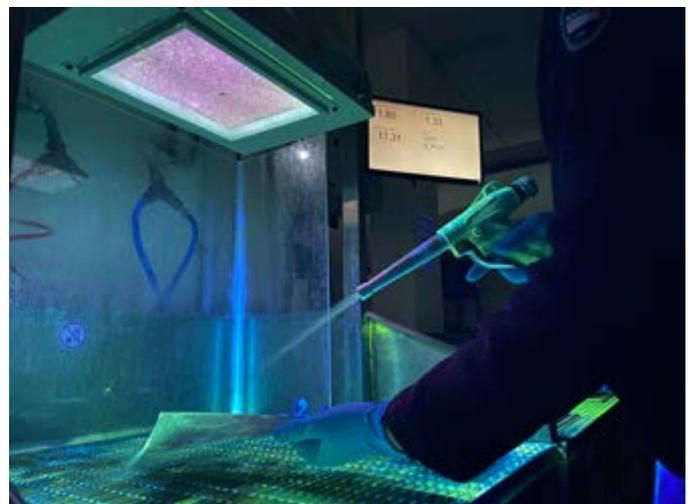
Eindringprüfung an Triebwerksschaufel
