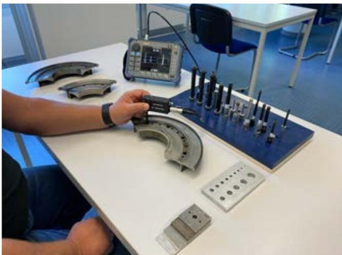
Wirbelstrom – Bohrungsprüfung
