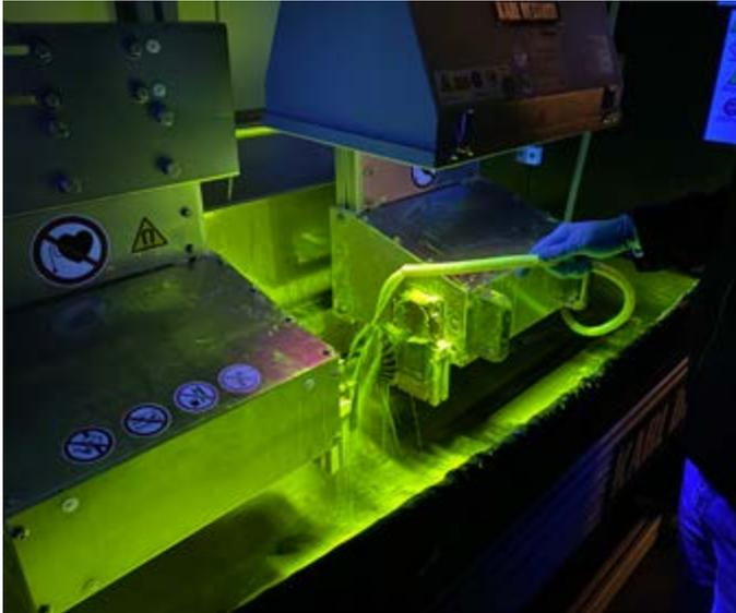
Magnetpulverprüfung an Getriebezahnrad
