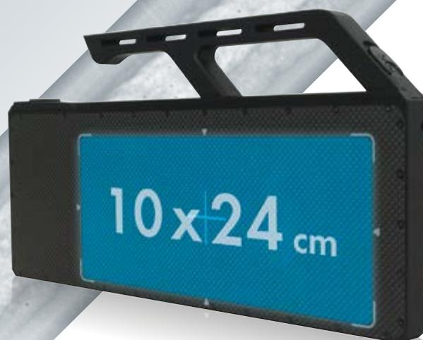
Der kompakte DRC 1024 NDT Flachdetektor wurde von Grund auf für die ZfP entwickelt. Mit seiner aktiven Fläche von 10x24cm ist er ein optimaler digitaler Filmersatz für eines der am häufigsten verwendeten Filmformate in der industriellen Radiographie. Die zugehörige Bildgebungs- und Analysesoftware D-Tect X unterstützt Sie mit allen Werkzeugen, die Sie für die Arbeit nach Industriestandards benötigen und sorgt dabei für einen zeitsparenden Workflow.
