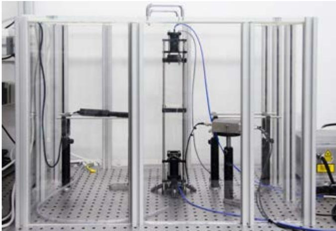
Abbildung 1: Transmissionsaufbau des verwendeten TERA K15 THz-TDS Systems mit Klebstoffprobe im Strahlengang.
