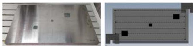
Abbildung 6: Grobblechsegment mit drei künstlich eingebrachten Hardspots (links), schematische Darstellung der Vermessung (rechts)
