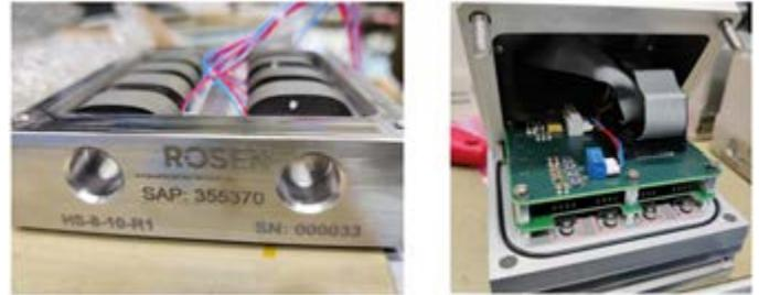
Abbildung 20: Sensorgehäuse (links) und Sensorelektronik (rechts)
