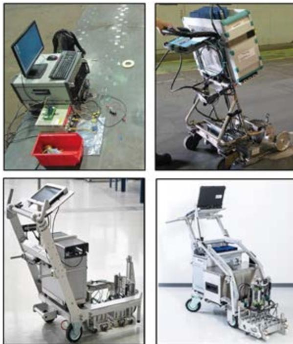
Abbildung 16: Achtkanaliger Sensorwagen (oben links Laboraufbau in Einsatzumgebung, oben rechts erster Prototyp, unten links erste Weiterentwicklung, unten rechts zweite Weiterentwicklung)
