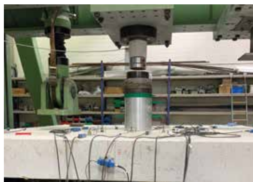
Foto von der Seitenansicht des Deckenknotens im eingebauten Zustand mit angekoppelten SE-Sensoren [17].
