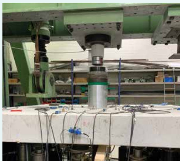
Fachbeitrag zur Schallemission an großmaßstäblichen Laborproben aus Beton
