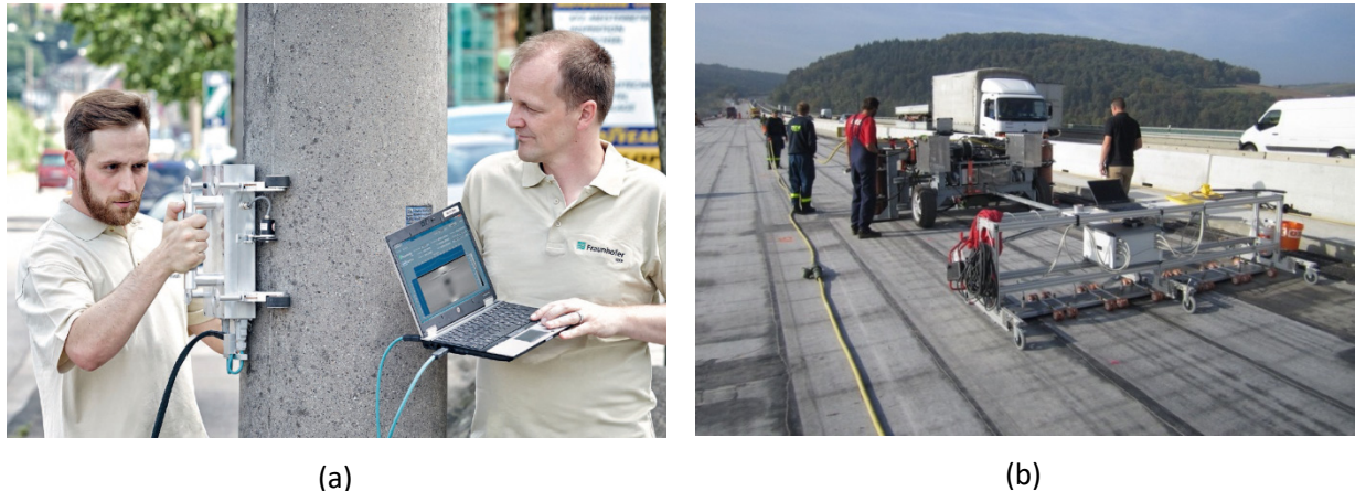
Bild 3: Mobile Streufluss-Prüftechnik für Spannbeton, (a) portables Prüfsystem für Betonmasten (Bildquelle: Fraunhofer IZFP/Bellhäuser/DGZfP-VNB 90/28.08.17); (b) MobiRem System zur Prüfung von Querspanngliedern (Bildquelle: Ingenieure für Bauwesen – Prof. Hillemeier & Knapp GmbH, Berlin/DGZfP-VNB 89/28.08.17).
