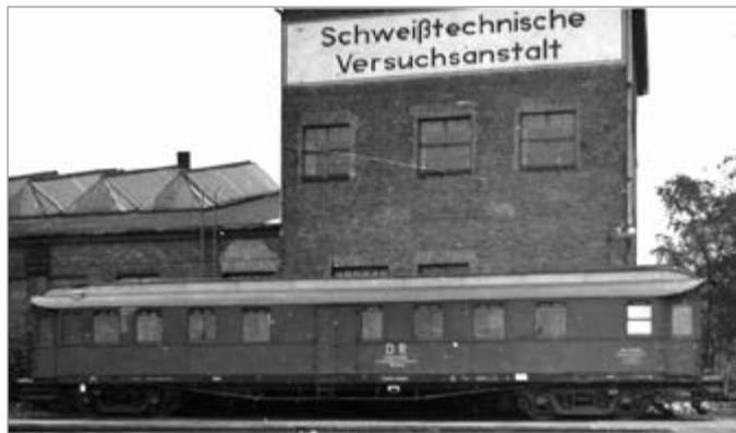
Abb. 8: Röntgenprüfwagen der Deutschen Reichsbahn (DR)
