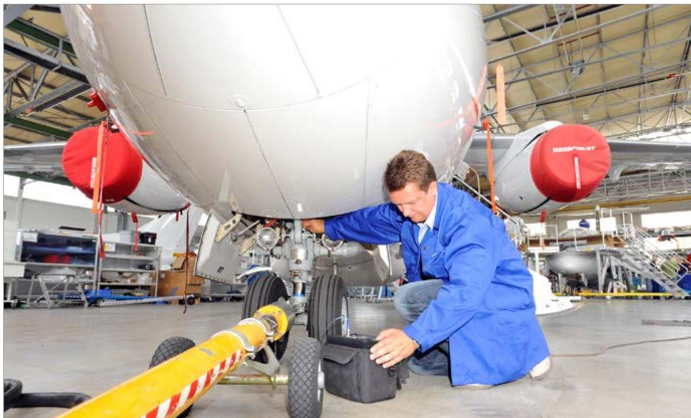
Uwe Elpelt bei der Ultraschallprüfung an einem Bugfahrwerk eines Dornier 328 Jet
