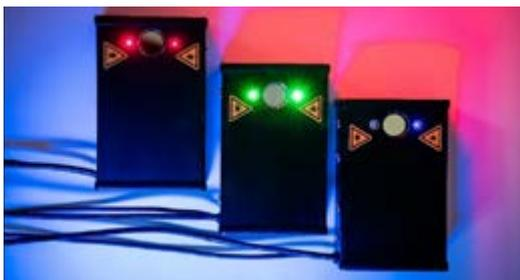
Abbildung 5. Die Messgeräte von TENTA VISION mit unterschiedlicher Lasertechnologie, v. l. n. r.: Messgerät TERRA mit 650 nm (rot), FLORA mit 520 nm (grün) und AQUA mit 450 nm (blau) Laserwellenlänge.
