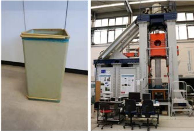
Abbildung 3: Dickwandige FKV-Struktur (links); Universalprüfmaschine (rechts)
