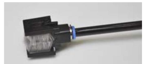
*Dank seiner verdichteten Bürsten umschließt I·Tip zu prüfende neuralgische Stellen an Kältemittelleitungen komplett. (Quelle: INFICON)*
