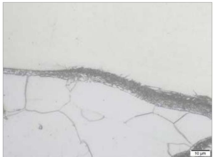
Abbildung 12: WEZ der Arbeitsprobe S1 mit ferritischem Grundwerkstoff (Matrixgefüge) und austenitischem Schweißgut mit geringer Aufmischungszone (ca. 10 %) sowie schmalem Martensitsaum (Mikroschliff poliert)
