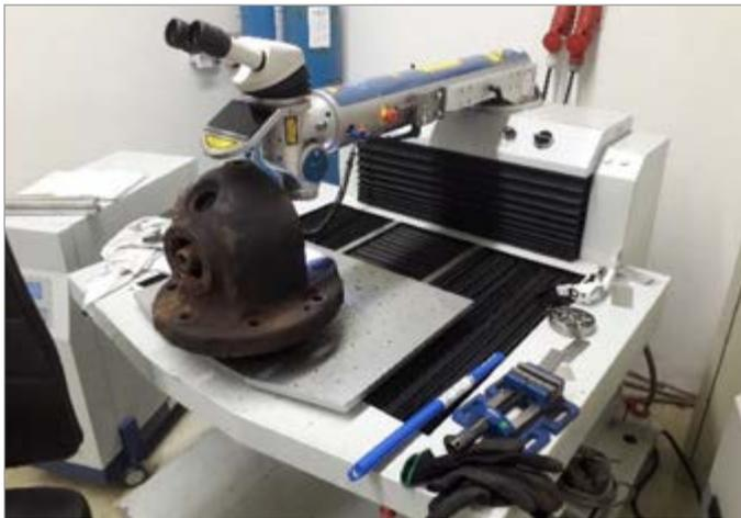
Abbildung 9: Zylinderkopf aus Lanz-Perlit auf einem Laserstrahlschweiß-Handarbeitsplatz
