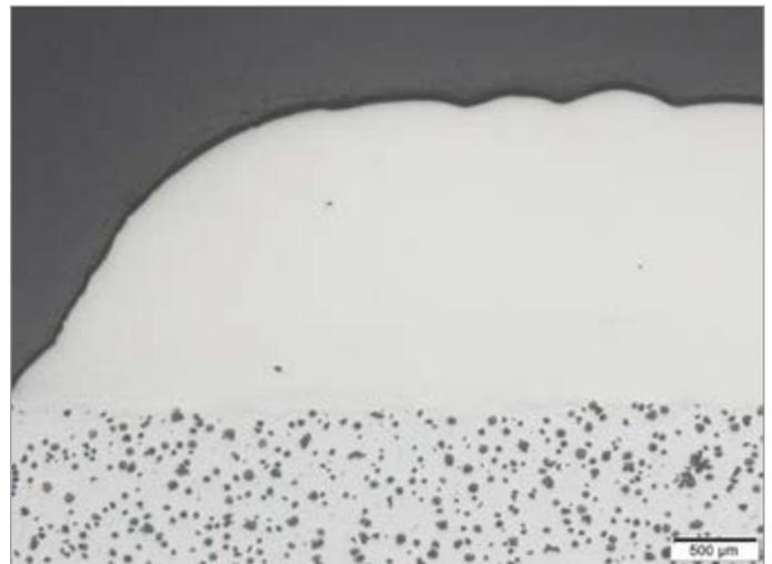
Abbildung 11: Übersicht über das artfremde Schweißgut auf Ni-Basis ohne innere Unregelmäßigkeiten (Mikroschliff, poliert) an Probe S1. Der Grundwerkstoff weist globulare Graphitausscheidungen auf.
