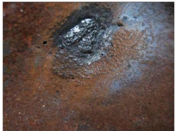
Abbildung 8: Ergebnis der Reparaturschweißung am Lanz Bulldog-Zylinderkopf aus Lanz-Perlit (nach heutigem Verständnis ca. EN GJL-300)
