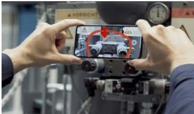
Bild: Smartphone Zuschaltung eines Kollegen inkl. Augmented Reality
