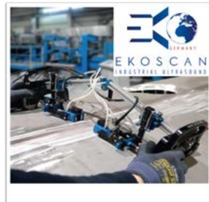
zur Schweißnahtprüfung, PA- und TOFD-Prüfköpfen inkl. passenden Vorlaufkeilen, Encoder und gratis Zubehör!
