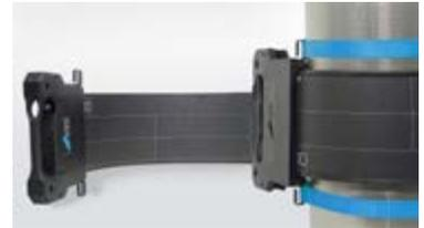
Biegbare Detektoren können traditionelle Röntgenfilme in einer Vielzahl von Branchen ersetzen, von der Öl- und Gasindustrie über die Energieerzeugung bis hin zur chemischen Industrie und Luftfahrt, und sie optimieren Inspektionen durch schnelle Bilderfassung und softwaregestützte Analyse.
