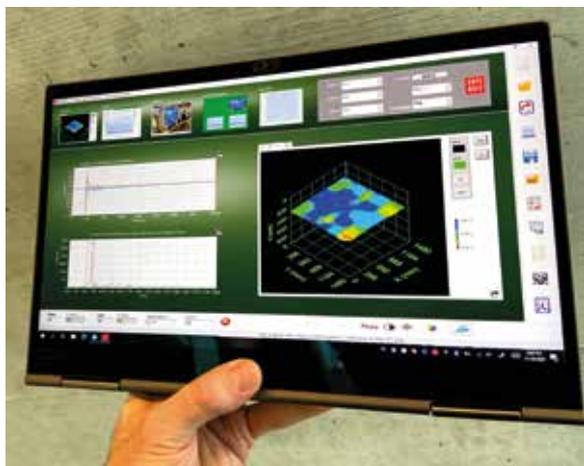
Abbildung 4: 3D-Schichtdickenprofildarstellung in ECHOLYST Software.
