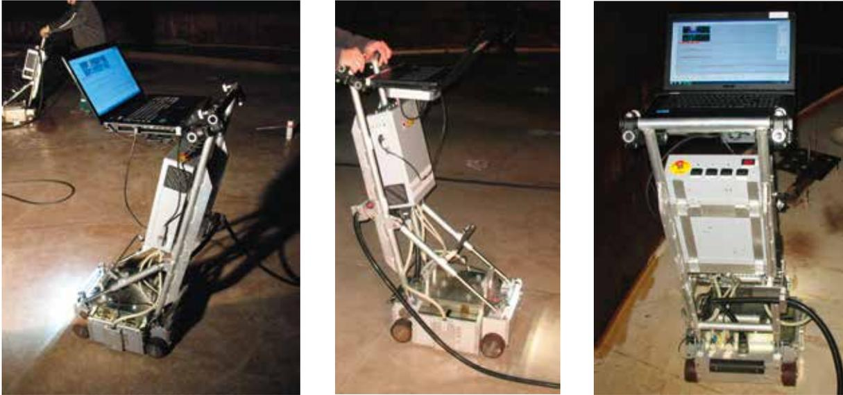
Abbildung 1: FIT-Tankbodenprüfgeräte im Einsatz.
