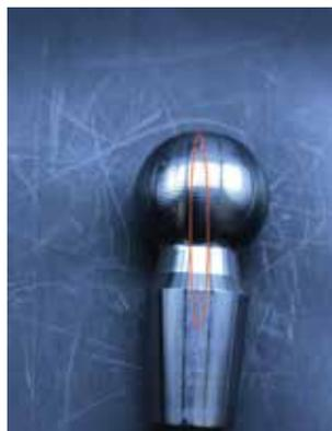
Abbildung 2 Kugelzapfen mit rissartiger Anzeige bei 504 Lx, rechts Detailaufnahme Anzeigebereich
