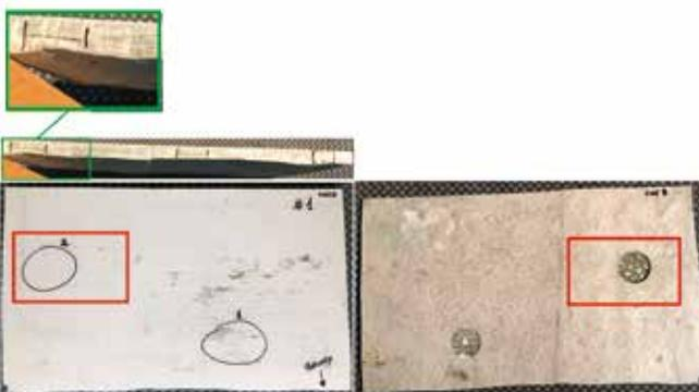
Abbildung 3: Bootswandausschnitt. Links: Oberseite und Seitenansicht mit Detailvergrößerung der Harzanreicherung (grün) sowie Scanbereich (rot). Rechts: Rückseite.
