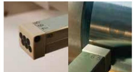
Bild 1: 8-fach Sensorarray mit sechs in zwei Reihen angeordneten Sensorelementen zur Laufflächenprüfung an Wälzlagerringen und je zwei  $90^\circ$  hierzu angeordneten Sensorelementen zur Prüfung der Anlaufborde
