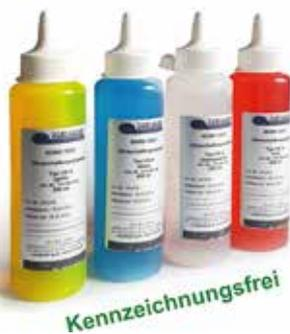
In der Ultraschallprüfung werden Koppelmittel eingesetzt, die verhindern, dass sich zwischen dem Ultraschall-Prüfkopf und der Prüfoberfläche ein Luftspalt bildet, der den Durchgang der Schallimpulse in den Werkstoff behindert. Die gängigen Produktnormen fordern – sehr allgemein ausgedrückt – die Eignung des verwendeten
