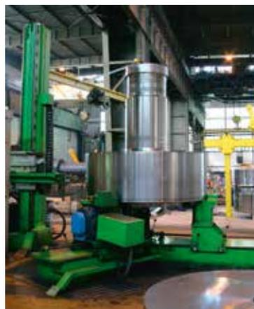
Abb. 1: Ultraschallprüfung eines großen Schmiedeteils 1953 [4] (links) und automatisiertes Ultraschallprüfsystem, das seit 1995 verwendet wird [2] (rechts).
