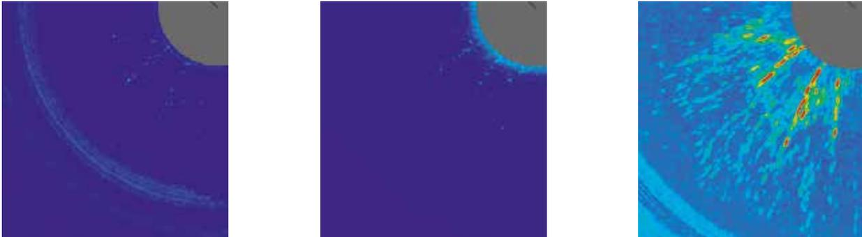
Abb. 13: SAFT Analyse von in radialer Richtung ausgedehnten Inhomogenitäten;
