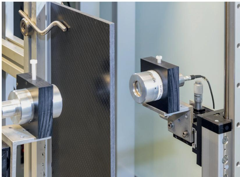
Abb. 11: Positionierung der Wandler bei der Durchschallung eines Testkörpers. Die Halterung mit Goniometern ermöglicht die Ausrichtung der Wandler.
