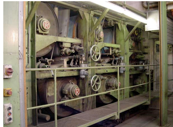
Abb. 10: Trockenzylinder in einer Trockengruppe einer Papiermaschine
