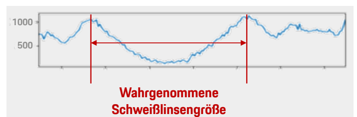
Abbildung 4: Wahrgenommenes Signal vom Schweißpunkt UT- Anwendung
