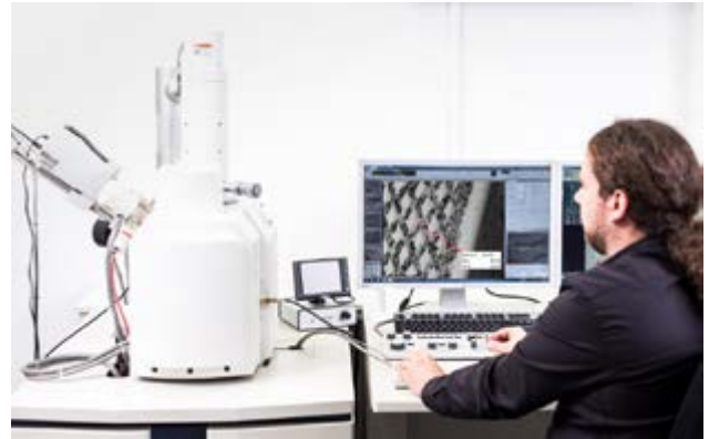
Falk Ahrens untersucht den mitgebrachten Stift im Rasterelektronenmikroskop
