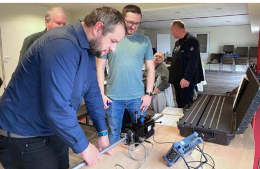
▲ Im Unterausschuss Ausbildung Wirbelstromprüfung wurde die Funktionalität der zukünftigen Prüfungsrohre getestet.
