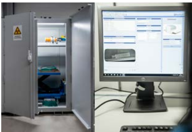
Digitale Radiographie mit 160 KV-Direktstrahler; zur Prüfung von Bauteilen bis zu einer Länge von ca. 1.200 mm
