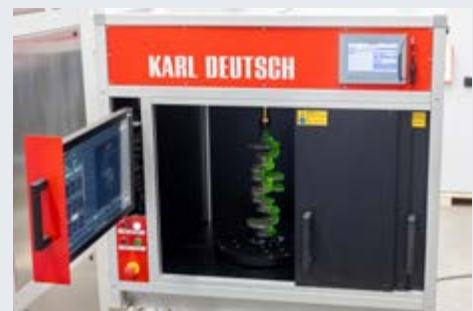
CRACKVIEW AI Prüfplatz zur Kamerabetrachtung
