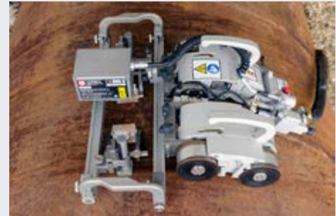
NAVIC2-Scanner für die Schweißnaht-Prüfung
