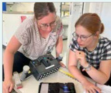
Spanngliedortung mit Ultraschall an einem Stufenkörper
