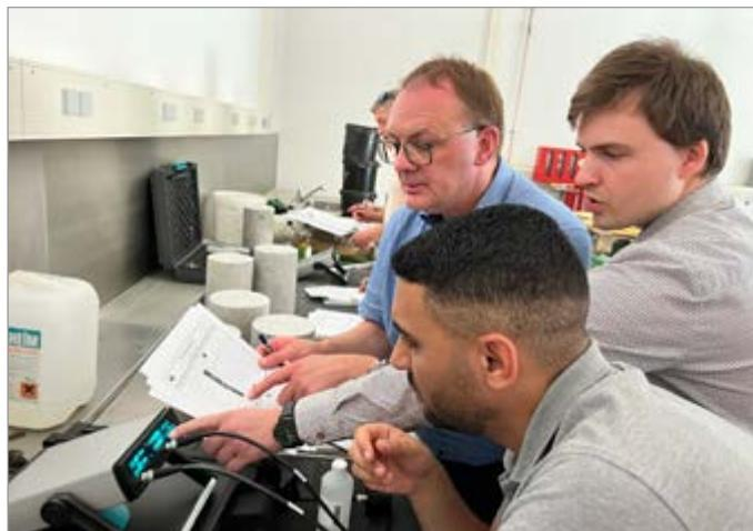
Spanngliedortung mit Ultraschall an einem Stufenkörper
