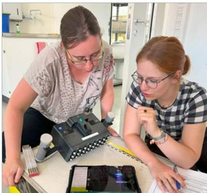
Druckfestigkeitsabschätzung mittels Laufzeitmessung
