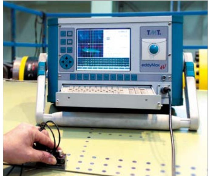
Prüfen einer genieteten Flugzeugstruktur mit Wirbelstrom
