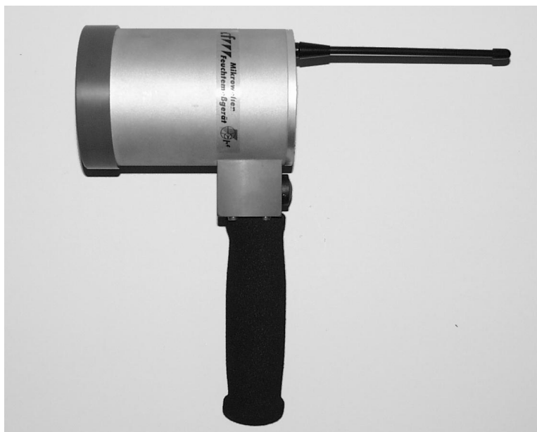
Abb.5 Handsonde zur Feuchtemessung mit Streufeldresonator und drahtloser Datenübertragung. Die Messung wird durch Druck auf einen Auslöseknopf eingeleitet
